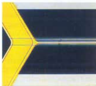
Fig. 1: Macro-cadru al cablului de încălzire al unui detector de conductivitate termică proiectat cu tehnologia pe bază de microcip
