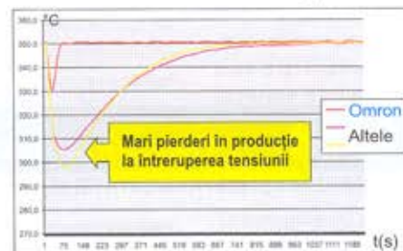
Platformă de teste pentru 3 regulatoare, conectate la 3 procese identice
